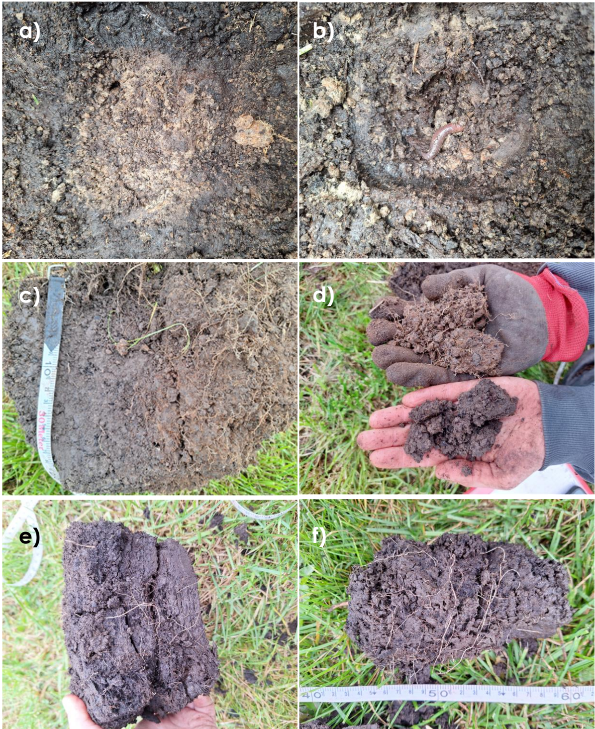
Figuur 8 Gaten gevuld met a) poldergrond met zichtbare wormengang, b) poldergrond met pendelaar, c) mengsel van poldergrond en boorsel, d) de gemengde grond in de gaten (onder) was vochtiger dan de grond buiten de gaten, e & f) enkel boorsel met beworteling door de schalterveenlaag in oktober 2024.
